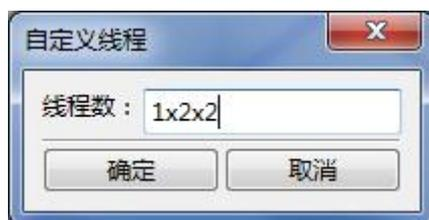
如上图所示，1x2x2 表示在 X 方向分配 1 个区域，Y 方向分配 2 个区域，Z 方向分配 2 个区域，总线程数为 4。
