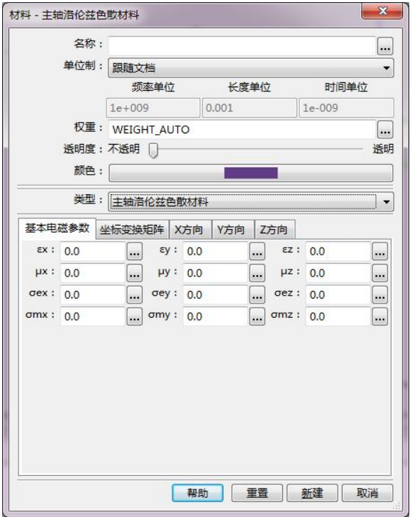
图 5-2-17-1 主轴洛伦兹色散材料参数设置（基本电磁参数）
