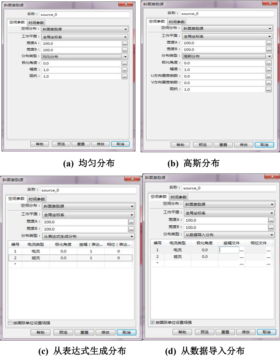
图 5-3-3-13-1 斜面激励源不同分布的参数设置
