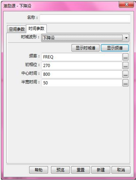
图 5-3-2-7 外部导入（下降沿）时间函数参数设置
