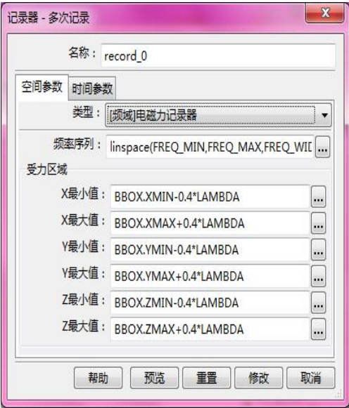
图 5-4-7-1 [频域]电磁力记录器参数设置
