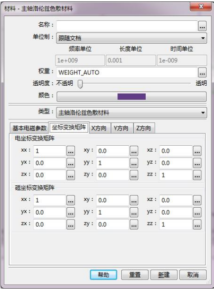
图 5-2-17-3 主轴洛伦兹色散材料参数设置（坐标变换矩阵）
