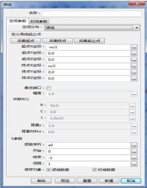
图 5-3-3-9-1 集总端口（带连接线）参数设置
