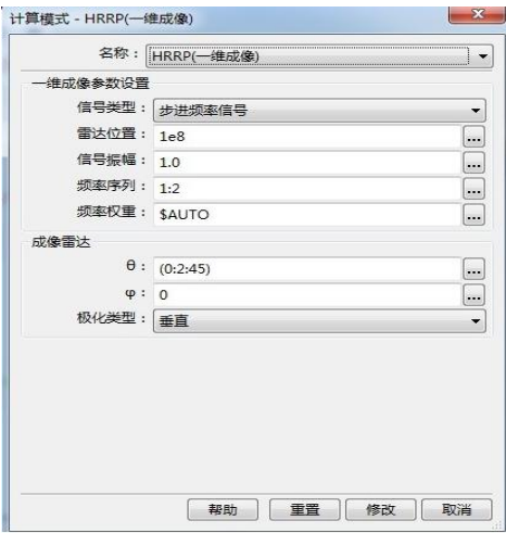
图 4-7-2-2 一维成像计算模式设置窗口
