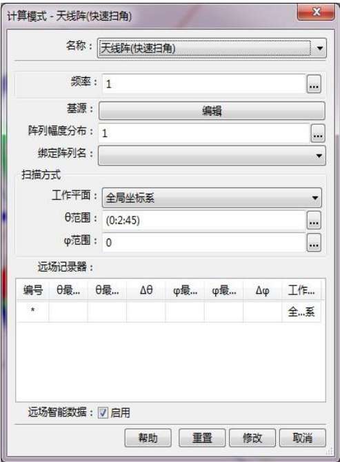
图 4-4-2-2 天线阵（快速扫角）计算模式设置窗口
