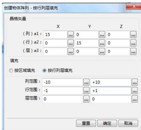
在 X 正负方向各扩展 10 个单元，Y 正负方向各扩展 1 个单元，创建 XY 平面内的  $21 \times 3$  阵列，单元间隔 15mm（约为半波长）。
