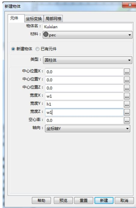
“材料”下拉菜单中选择材料 pec，中心坐标为  $(0, 0, 0)$ ，宽度为  $(w1, h1, w1)$ ，轴向沿 Y 轴。
